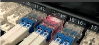
嵌合先や反対端から可視光( $\lambda=650\text{nm}$ )を挿入することで、アダプタの内部が赤く光り、挿抜する光ケーブルを容易に識別可能
