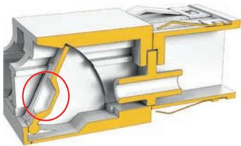
シャッターが独立して動作することで、一部のポートのみを使用しても防塵機能を保ち、通信光から目を保護します。
